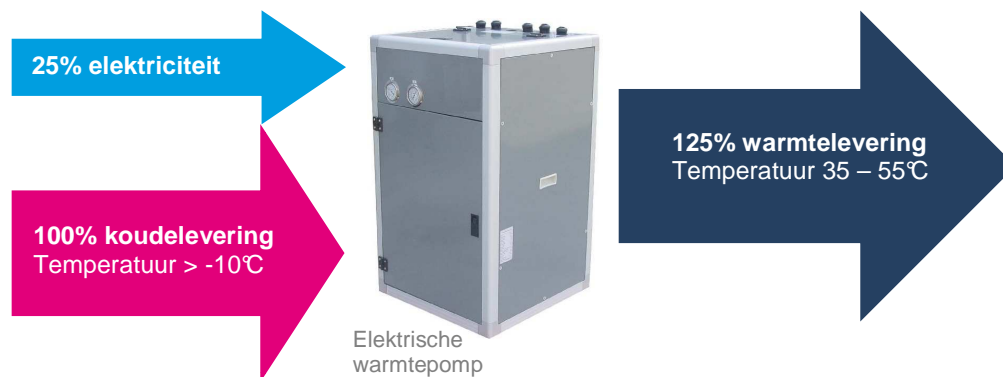
figuur 3.2 Schematische weergave van een elektrische warmtepomp
